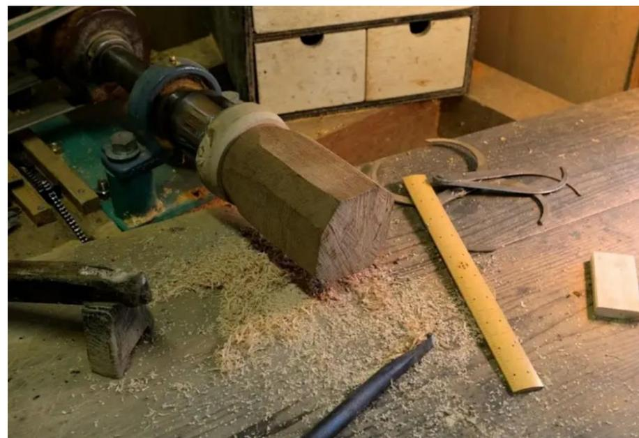
Сняв внешний слой и выровняв углы заготовки, приступаем к первичной грубой обработке её внешней поверхности на токарном станке. При обработке нужно учитывать, что дерево в дальнейшем может ужаться или деформироваться при высыхании, поэтому заготовка обтачивается по большему размеру, чем планируется для готового изделия.
