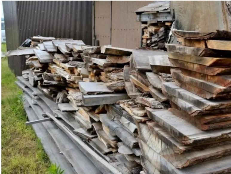
Из-за плотной структуры сосудов этого дерева, свойства древесины дикой сакуры, которую в больших количествах добывают в Тоттори, отличаются высокой твёрдостью и прочностью, а потому она отлично подходит для изготовления посуды. Также одной из привлекательных черт деревянных изделий считается то, что цвет дерева со временем постепенно меняется.
