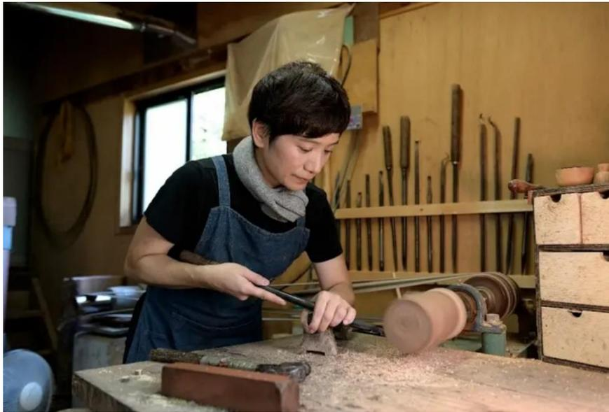
Дальше вытачивается полость внутренней части заготовки.
