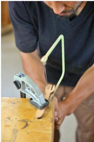
Для того чтобы вырезать более мелкие детали, например зубья вилки, используется ручная ножовка.
