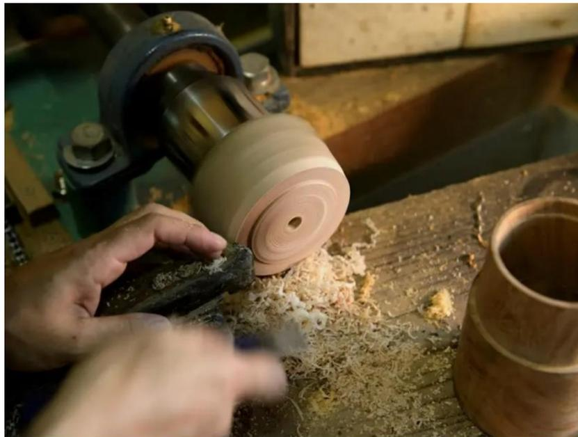
Дальше уже сама заготовка крепится на планшайбу и устанавливается на станок.
